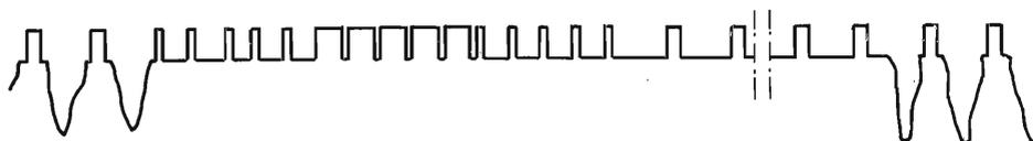
Fig. 50. - Onda modulante completa dei picchi di sincronismo. Da sinistra a destra: picchi sincronismo di riga, equalizzatori, picchi di quadro, equalizzatori e nuovamente picchi sincronismo di riga.
